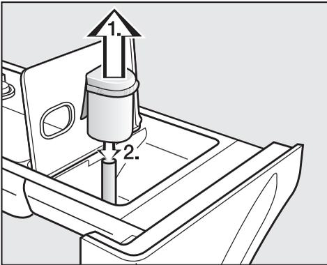
1. Saugheber aus der Kammer ☞ herausziehen und unter fließendem warmen Wasser reinigen. Das Rohr, über das der Saugheber gesteckt wird, ebenfalls reinigen.
