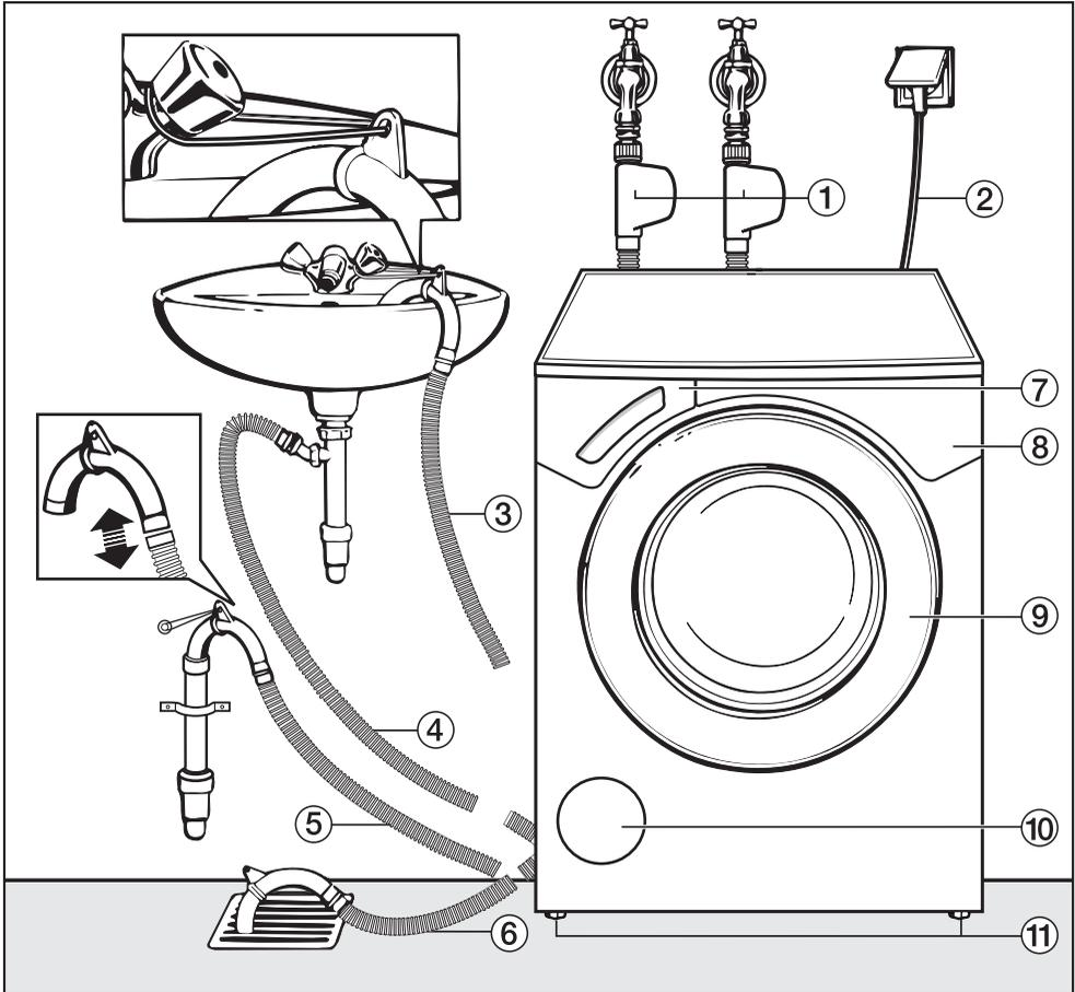
① Zulaufschläuche Waterproof-System für Trinkwasser und alternative Wasserarten
