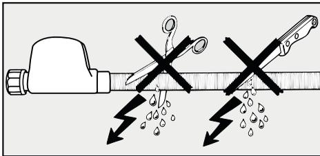
**Die Schutzhülle darf nicht beschädigt oder geknickt werden.**
